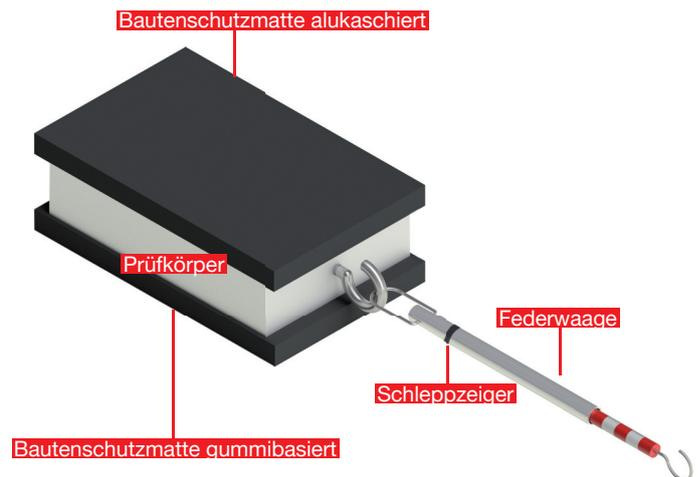
Beim Flachdach-Montagesystem ALTEC FD\_OPTIFLEX-10 ist der Haftreibungs-Koeffizient  $\mu$  ein maßgebender Wert für die Ermittlung des Ballasts gegen Verschieben. Dieser Wert  $\mu$  wird zwischen Dachhaut und Bautenschutzmatte ermittelt. Die Größe des Beiwerts ist von der Beschaffenheit der Dachhaut (nass/trocken, rauh/glatt, verwittert/neu) abhängig. Deshalb ist es wichtig, diesen Wert für jedes Dach zu ermitteln.
