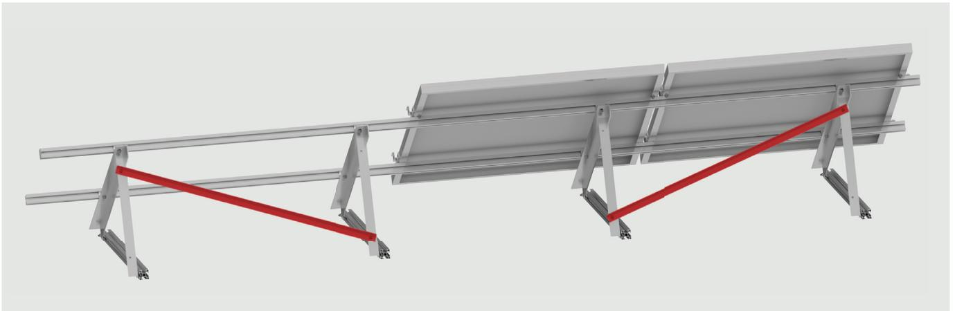
Die Diagonalstrebe ④ ist werkseitig mit einer Bohrung versehen. Die Diagonalstreben auf Länge schneiden und die zweite Bohrung  $\varnothing 9$  anbringen. Die Diagonalstreben werden mit den beiliegenden Sechskantschrauben und Sperrzahnmuttern am Stützwinkel ② montiert, mit der oberen Bohrung beginnend:
