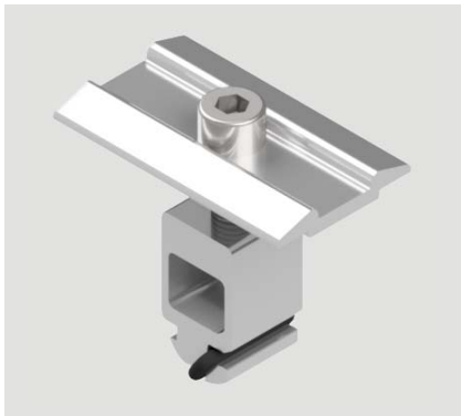
Mittelklemme universal mit Zylinderkopfschraube M8 (Modulabstand 20 mm)
