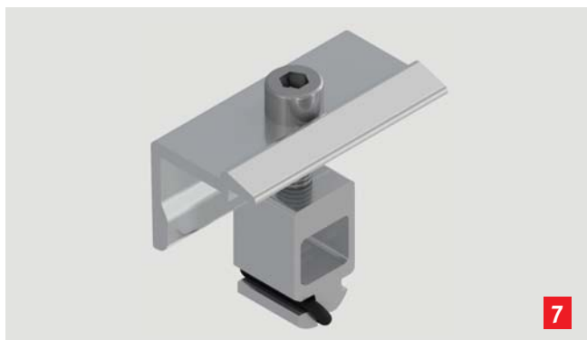
Endklemme universal mit Zylinderkopfschraube M8 für Modulhöhe 30–40 mm oder 41–46 mm für Hochstütze
