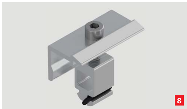
Endklemme universal mit Zylinderkopfschraube M8 für Modulhöhe 30–40 mm oder 41–46 mm für Startstütze und Doppelstütze
