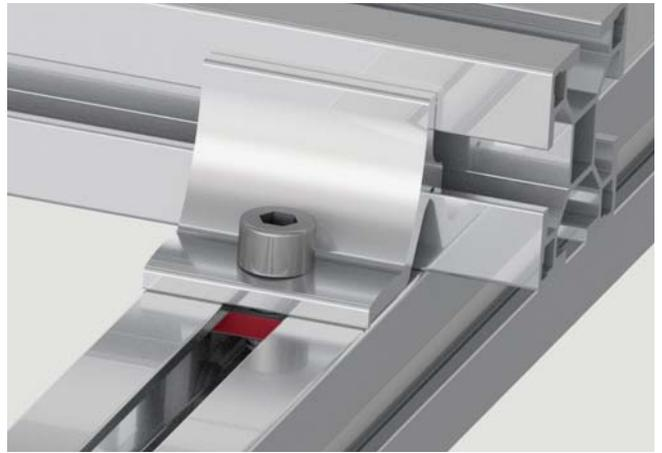
Die Gewindeplatte wird in die Nut des unteren Profils eingefädelt und die Nase des Kreuzverbinders in die Nut des oberen Profils eingehängt. Zylinderkopfschraube mit 14 Nm anziehen und darauf achten, dass sich die Gewindeplatte um 90° dreht. Die Gewindeplatte ist mit Schraubensicherung an die Schraube geklebt, beim Verschrauben löst sich die Gewindeplatte).
