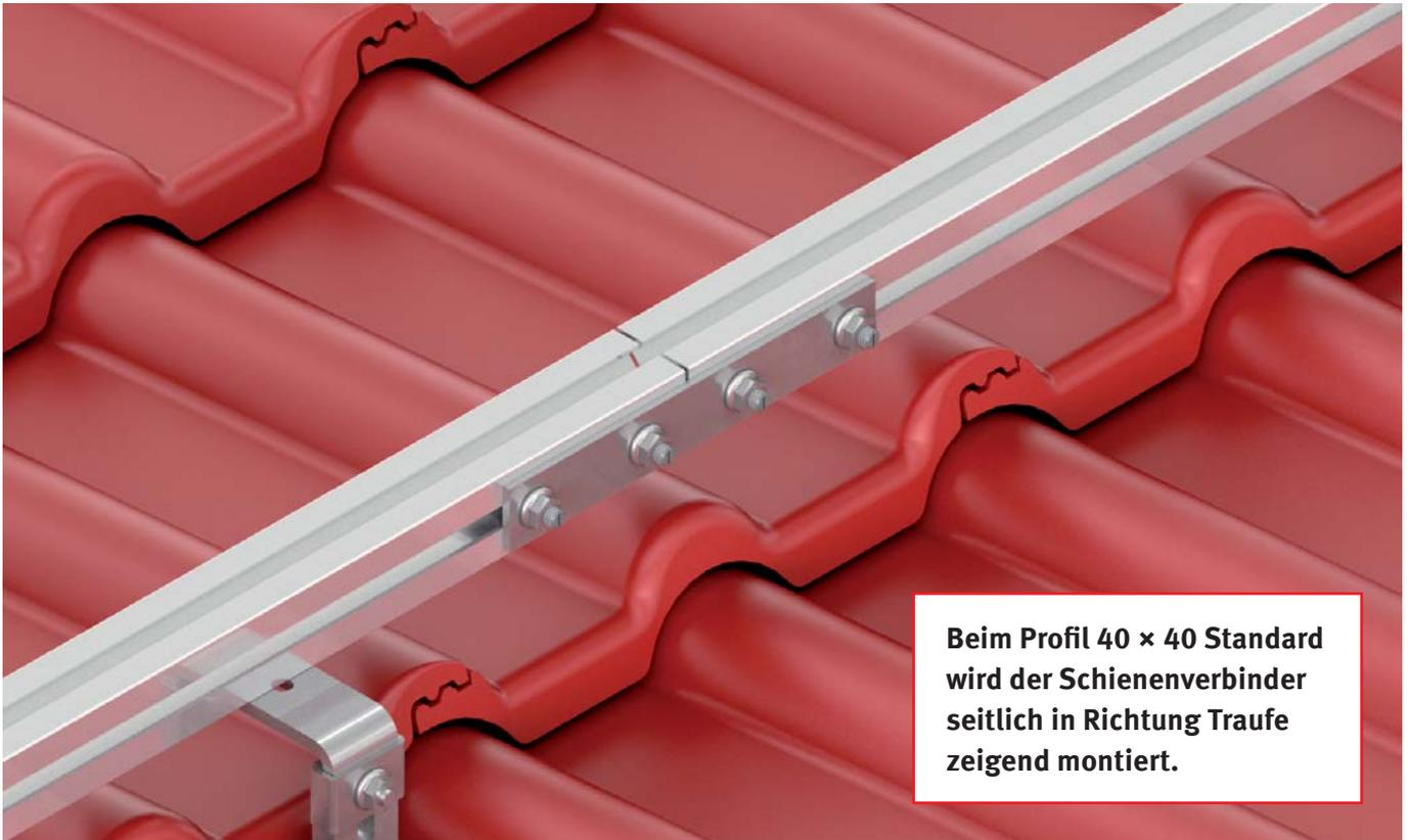
Der Schienenverbinder ist mittig über den Schienenstoß zu montieren. Die Hammerkopfschrauben des Schienenverbinders ins Profil einfädeln, um 90° drehen und mit 15 Nm festschrauben. Am Schlitz in der Schraube kontrollieren, ob die Schraube korrekt sitzt.
