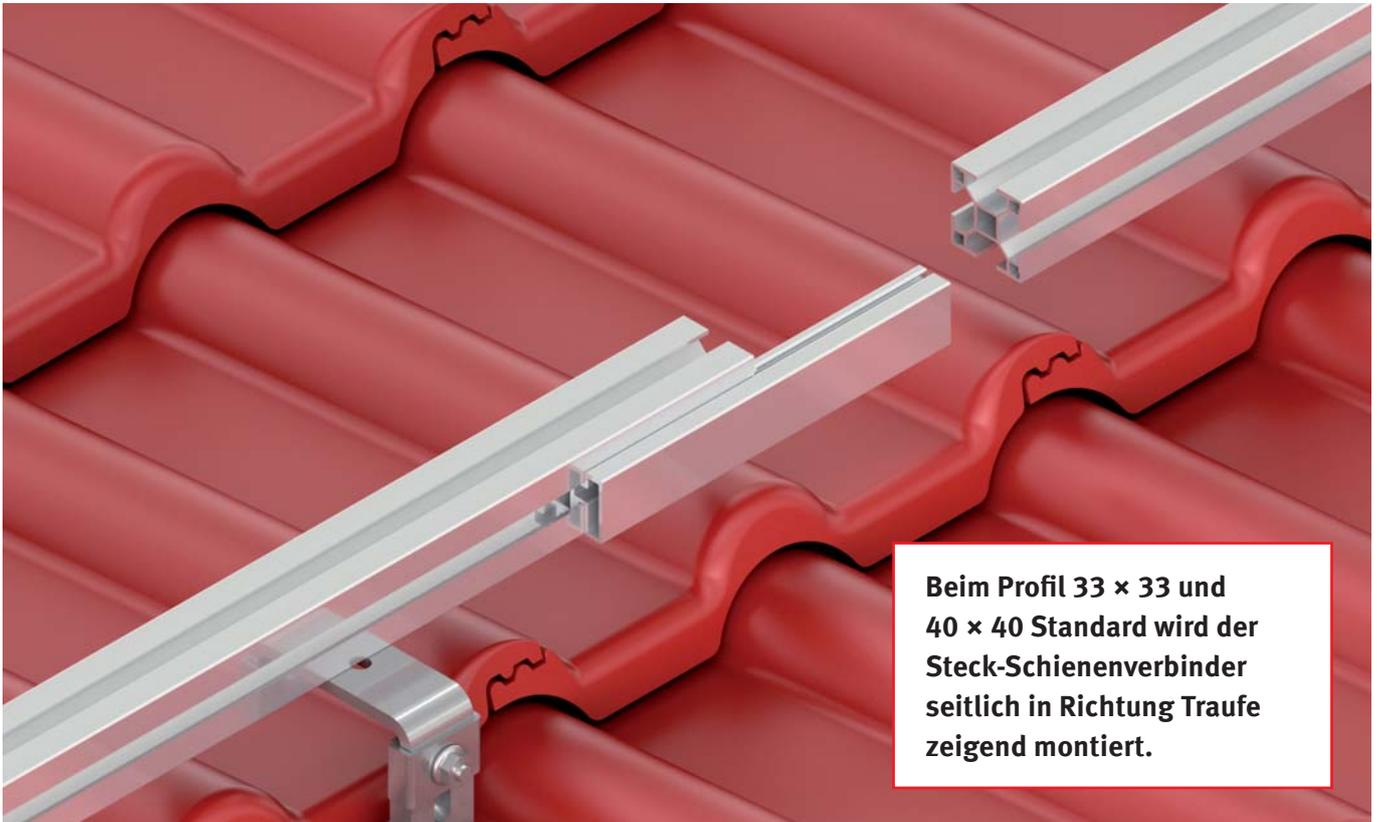
Der Steck-Schienenverbinder wird bis zur Einkerbung in das bereits ausgelegte Profil geschoben. Anschließend wird das nächste Profil auf den Steck-Schienenverbinder geschoben. Danach werden die Hammerkopfschrauben zwischen Dachbefestigung und Schiene mit 15 Nm angezogen.
