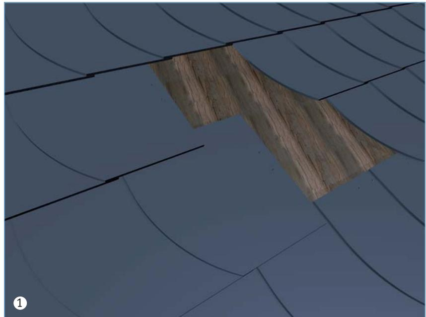
1 Die Dacheindeckung wird an der Stelle, an welcher der Dachhaken eingesetzt wird entfernt.
