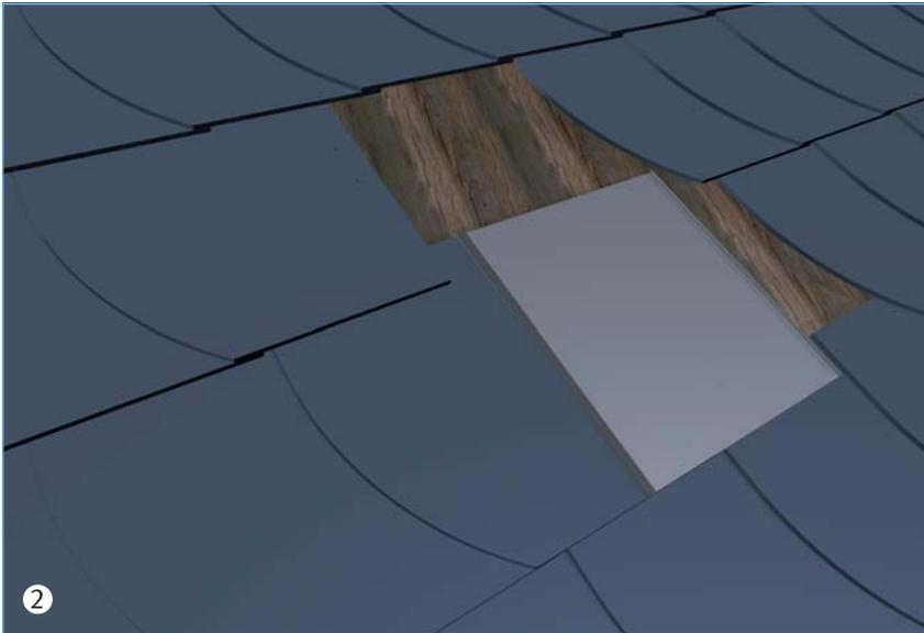
Die entfernte Schieferplatte wird durch das von ALTEC Metalltechnik GmbH oder Ihrem Dachdecker gelieferte Eindeckblech aus Aluminium oder Edelstahl ersetzt. Die Größe muss vor Ort passend zugeschnitten werden. Der nach oben gebogene Rand des Eindeckblechs hält den oberhalb liegenden Schiefer in der entsprechenden Höhe. Das Blech wird mit 2 Schrauben  $4 \times 25$  mm befestigt. Wir empfehlen, Quellband zwischen Eindeckblech und Schiefer zu kleben.
