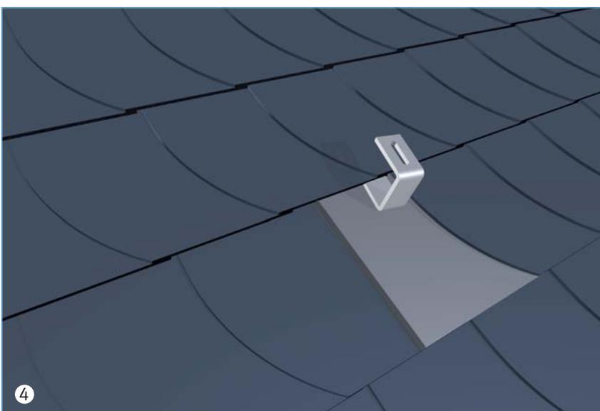
Der Schieferdachhaken wird auf dem Blech mit 3 Senkkopfschrauben  $6 \times 80$  mm durch die Schalung im Sparren befestigt. Anschließend umliegende Schieferziegel wieder einsetzen.
