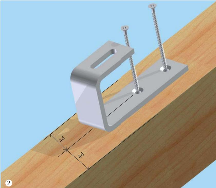
Bei der Verwendung von Holzschrauben ist das Vorbohren gemäß Zulassung zu prüfen.
