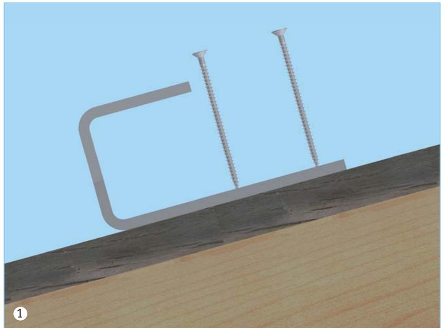
Der Dachhaken wird auf die Dacheindeckung aufgelegt und mit 2 Senkkopfholzschrauben 6 × 80 durch die Schalung im Sparren befestigt.
